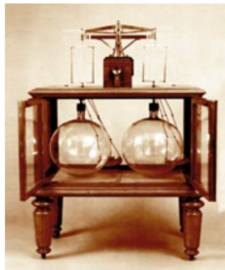
▲ Весы, сконструированные Д. И. Менделеевым для взвешивания газообразных и твёрдых веществ
